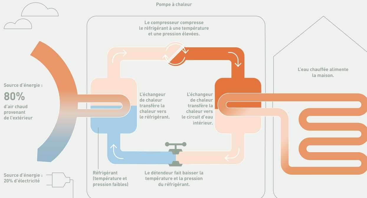
Avec Aquarea, jusqu'à 80% de la chaleur requise est extraite de l'air extérieur. Grâce à la performance d'Aquarea, l'énergie thermique capturée dans l'air extérieur est automatiquement transférée pour chauffer l'eau qui peut alors être utilisée par le système de chauffage et satisfaire tous les besoins en eau chaude sanitaire, ainsi que pour rafraîchir la maison si nécessaire.
