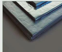
Les PIV U-Vacua™ sont constitués d'un noyau en fibre de verre unique, enveloppé dans un film stratifié constitué de plusieurs couches qui comprennent du nylon, de l'aluminium, et une couche protectrice. La pression intérieure est réduite à un vide de 1 à 20 Pa, ce qui minimise la conductivité thermique.
